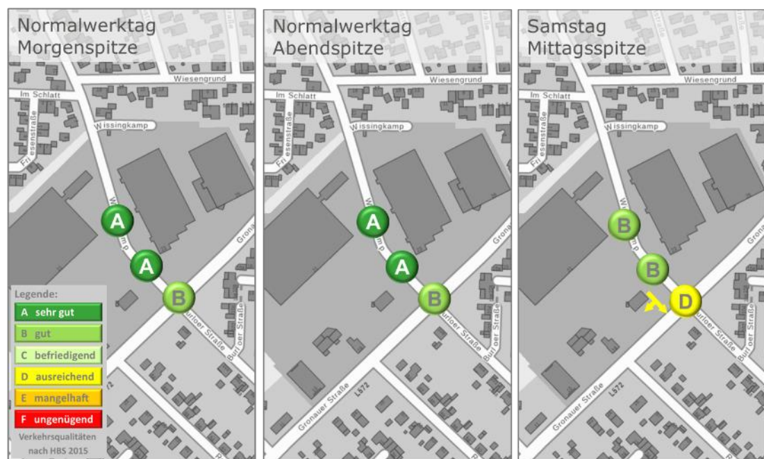
Abbildung 8: Rechnerische Leistungsfähigkeitsnachweise für den Prognose-Nullfall – Normalwerktag
