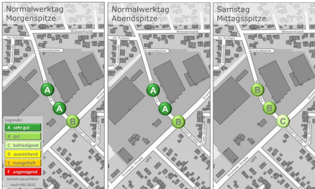
Abbildung 5: Rechnerische Leistungsfähigkeitsnachweise für den Bestand
