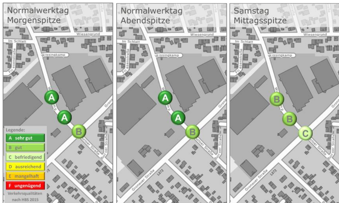
Abbildung 11: Rechnerische Leistungsfähigkeitsnachweise für den Prognose-Planfall- Normalwerktag
