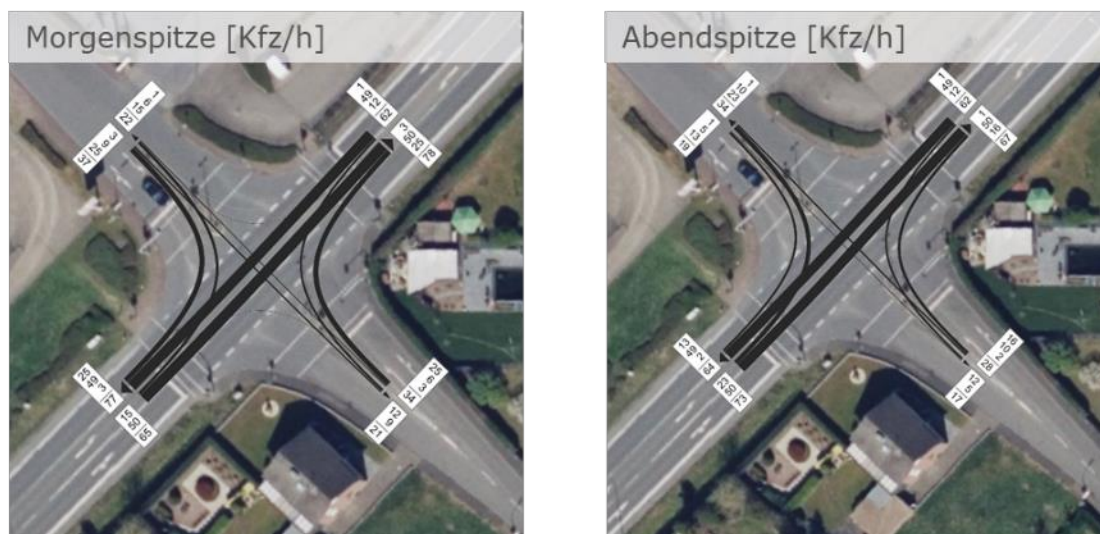
Abbildung 7: Verkehrszunahmen am Knotenpunkt Gronauer Straße / Wissingkamp im Prognose-Nullfall
