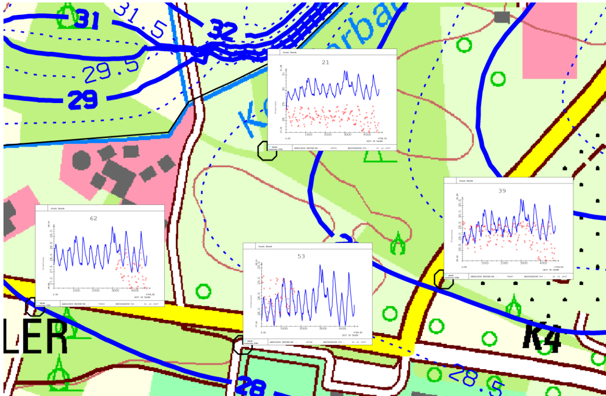
Abbildung 28: Vergleich gemessene (rot) und gerechnete (blau) Grundwasserstände am Oberlauf des Kettelerbaches
